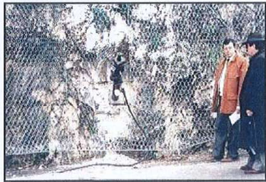
IRATTO DEL COSTONE ROCCIOSO E CONTROLLO DISTRUTTIVO DELLE CHIODATURE -S.P. CAPRI-ANACAPRI
